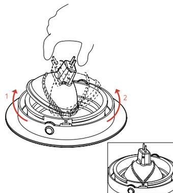
5. Faça a ligação a rede elétrica local isolando-o corretamente (verifique se há necessidade do uso do transformador em algumas luminárias). Encaixe a lâmpada no soquete. Encaixe a peça na moldura já fixada ao teto ao encaixar, você ouvirá um "CLICK".
